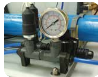
Превключватели за високо и ниско налягане и манометър.
