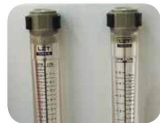
Дебитомери измерват концентрата и пермеата.
